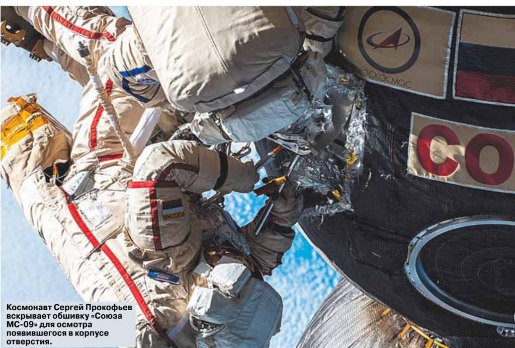
Космонавт Сергей Прокофьев вскрывает обшивку «Союза МС-09» для осмотра отвалившегося в корпусе отверстия.
