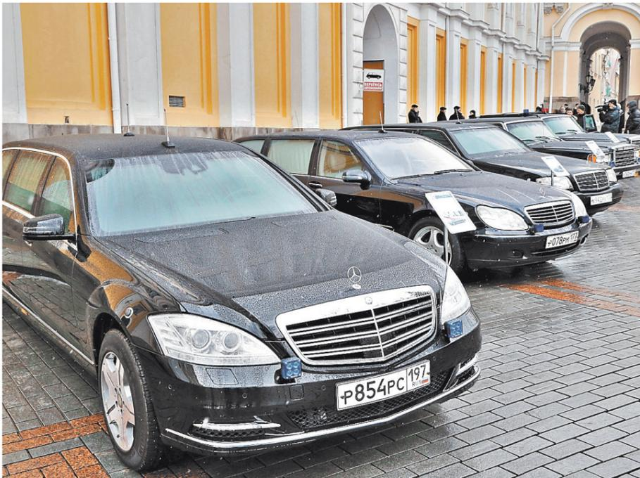
«Мерседесы» ГОНа: заводское бронирование, кузов удлиннен на метр, система аварийного пробега позволит проехать 30 км со скоростью до 80 км в час при резком падении давления в шинах.
